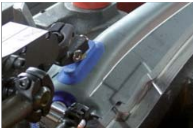
杯型吸盘 SAOG 应用于搬运表面拱度高的金属件
