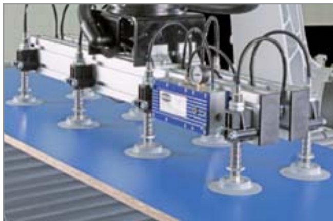
多级真空发生器 SEM 应用于搬运镀膜木板
