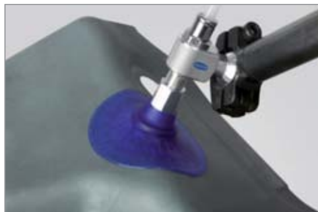
杯型吸盘 SAXM 应用于搬运成形金属部件
