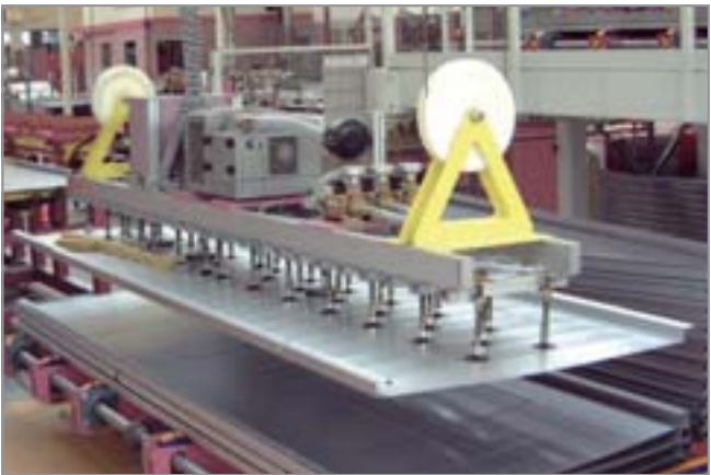
扁平吸盘 PFYN VU1 应用于搬运大型金属薄板
