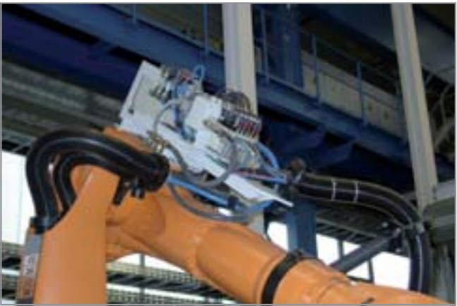
集成式真空发生器 SMP 应用于集中式真空产生装置系统
