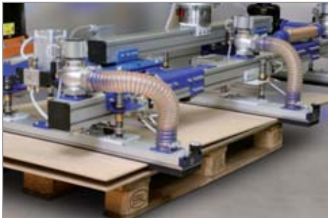
真空端拾器 SSP-FMC 采用可伸缩式设计搬运刨花板
