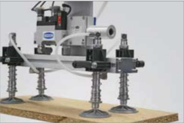
多级真空发生器 SEM-C 应用于搬运刨花板
