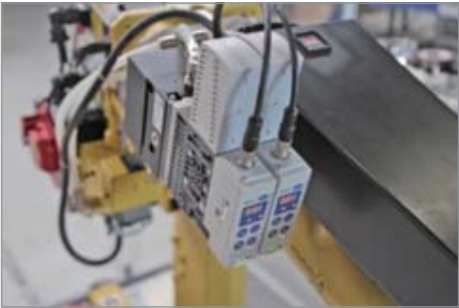
集成式真空发生器 SXPi / SXMPi 应用于集中式真空产生装置
