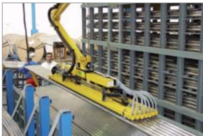
波纹吸盘 FSGB (3.5 折) 应用于搬运管材
