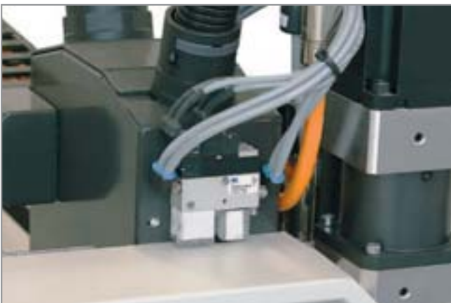
集成式真空发生器 SCPM 应用于集中式真空发生系统
