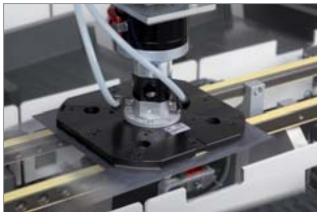
光伏吸盘 SWGm 应用于搬运太阳能电池片
