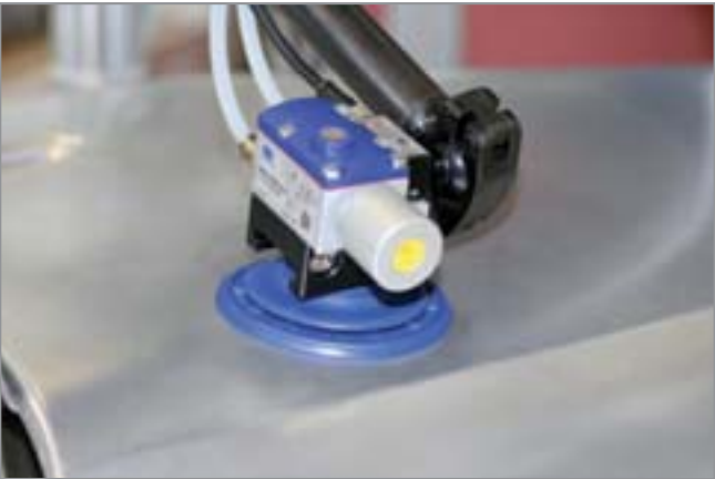
真空发生器 SEAC RP 直接连接吸盘的应用实例
