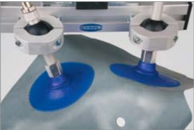
带有通用固定夹 HTR-UNI 的真空吸盘应用于搬运金属板材
