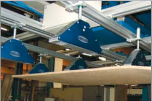
针式吸盘 SNG-D / DV 应用于搬运绝缘垫
