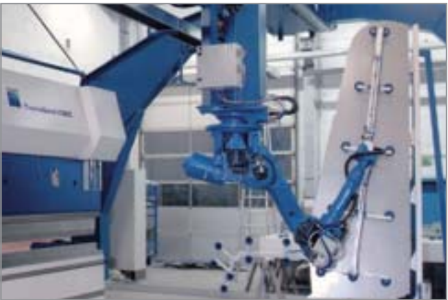
扁平吸盘 SAF 应用于搬运金属薄板
