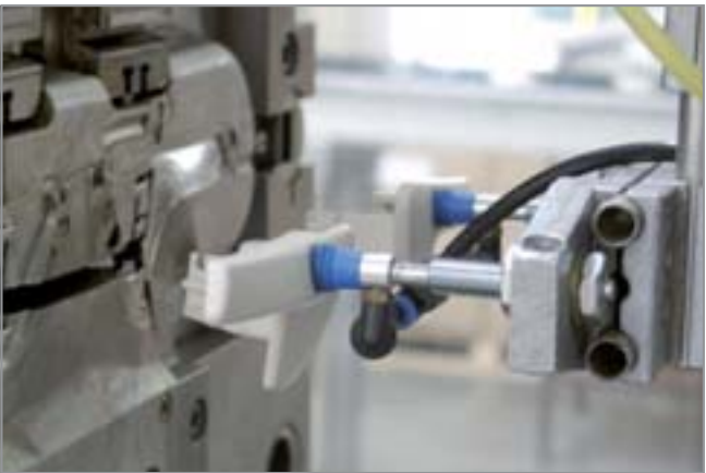
波纹吸盘 FSG 应用于搬运高温注塑件
