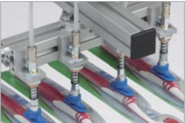
扁平吸盘 SGON 应用于搬运泡罩包装
