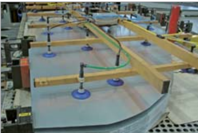
弹簧缓冲支杆 FSTI 安装实例
