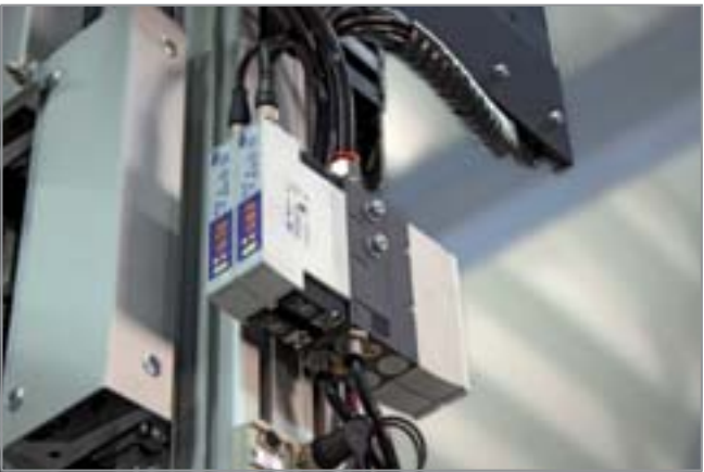
集成式真空发生器 SCPI / SMPi 应用于集中式真空产生装置
