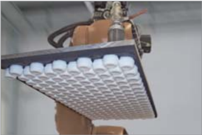
整层搬运的真空夹具系统 SPZ (无机械式夹具)
