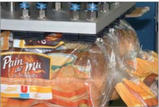
波纹吸盘 FSGB-R 应用于搬运袋装切片面包
