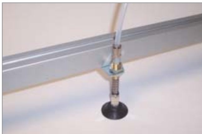
固定夹 HTR-STA FL 安装实例
