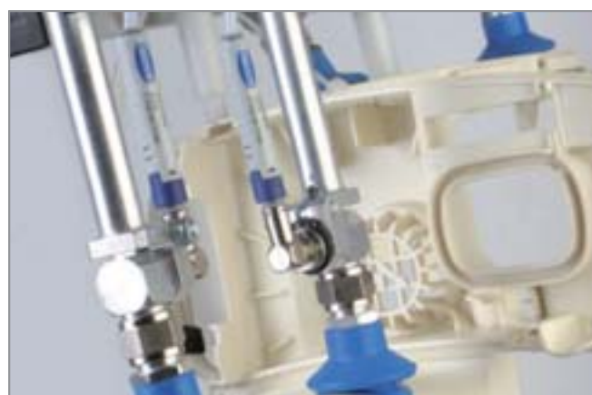
线型真空发生器 SLP 应用于搬运注塑件
