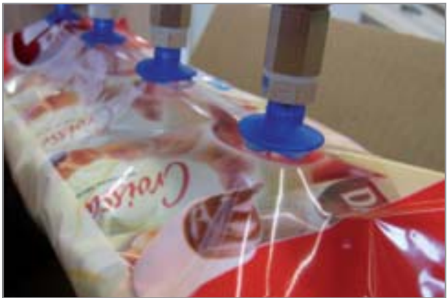
波纹吸盘 FGA PVC 应用于抓取软袋包装
