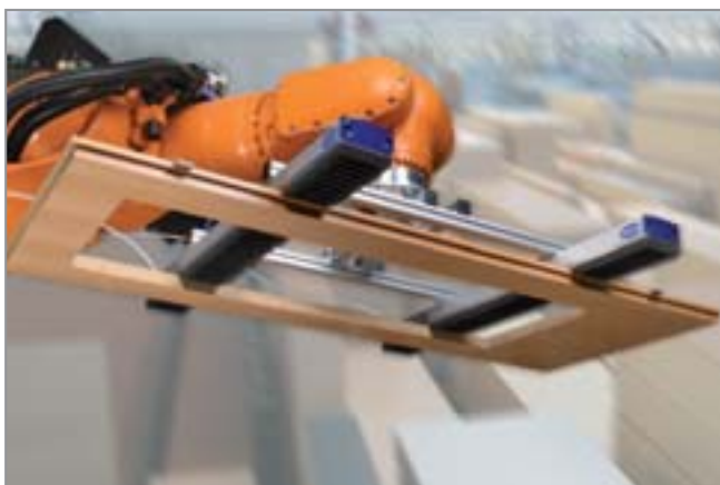
用于搬运木门的大面积真空夹具系统 FXC/FMC
