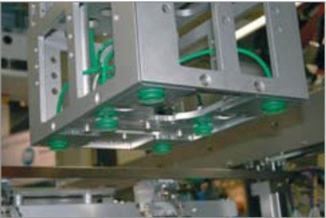
波纹吸盘 SPB1 应用于顶部装载设备
