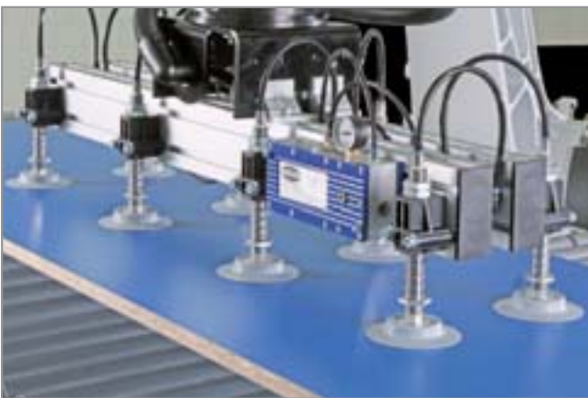
弹簧缓冲支杆 FSTF 应用实例
