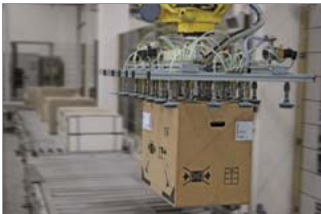
真空端拾器 SSP 搬运各类大型纸板箱
