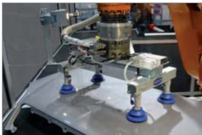
带有线型阀 IV 的真空吸盘应用于搬运白车身部件
