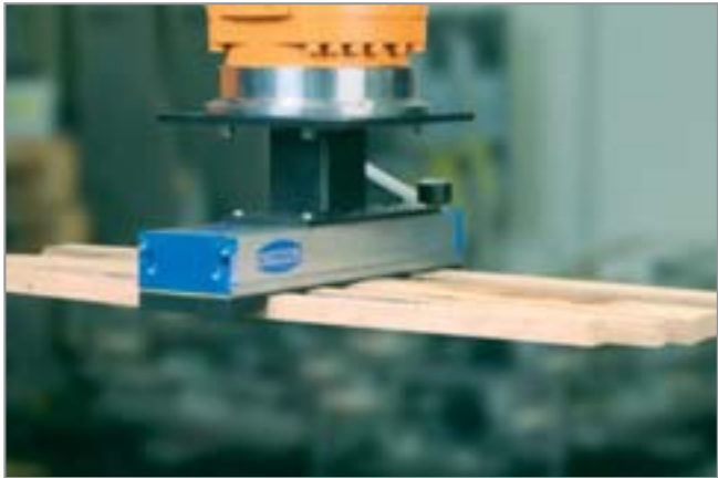
大面积真空夹具系统 FXC 搬运木板
