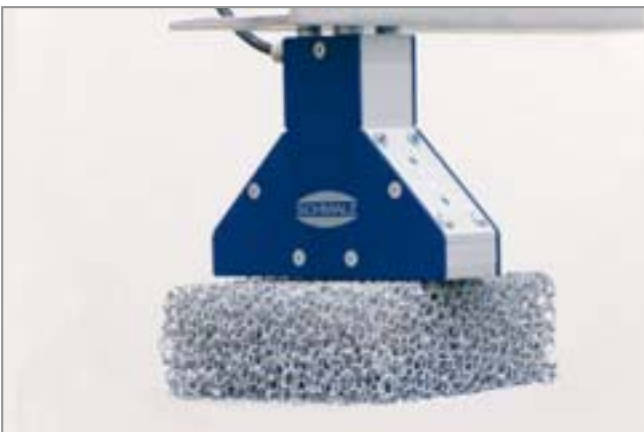
针式吸盘 SNG-YV 应用于搬运泡沫金属
